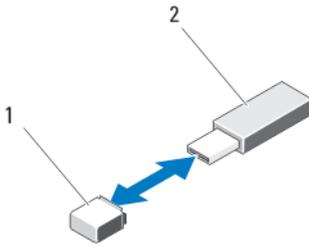
**Ilustración 13. Sustitución de la memoria USB**
