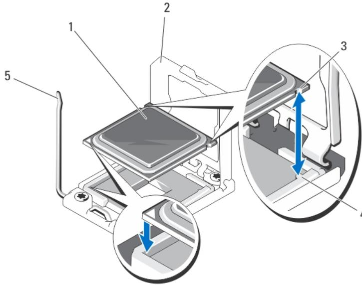
**Ilustración 16. Extracción e instalación de un procesador**
