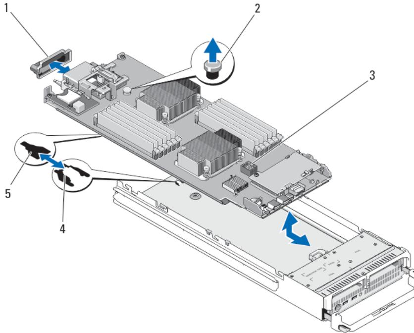
**Ilustración 20. Extracción e instalación de la placa base**
